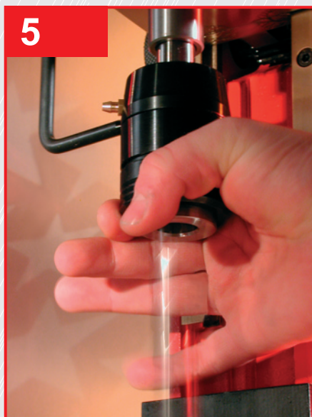
Рис. 4: Чтобы извлечь фрезу потяните стопорное кольцо вверх.
