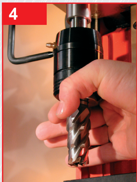
Рис. 3: Корончатая фреза зафиксирована в EasyLock. Можно начинать работу.
