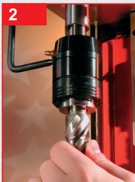
Рис. 3: Корончатая фреза зафиксирована в EasyLock. Можно начинать работу.
