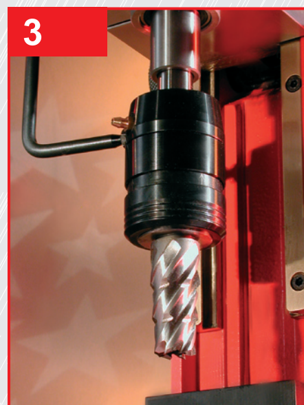
Рис. 4: Чтобы извлечь фрезу потяните стопорное кольцо вверх.
